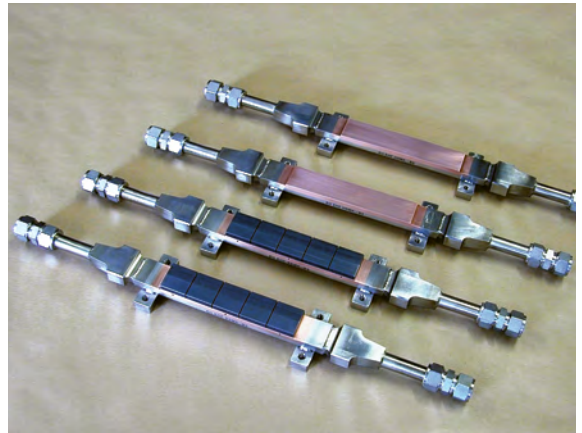
Mock-ups of ICH antenna Faraday screen bars
