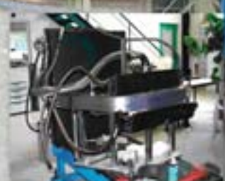
Maqueta 1:1 del blanc vertical del divertor provat a Framatome
